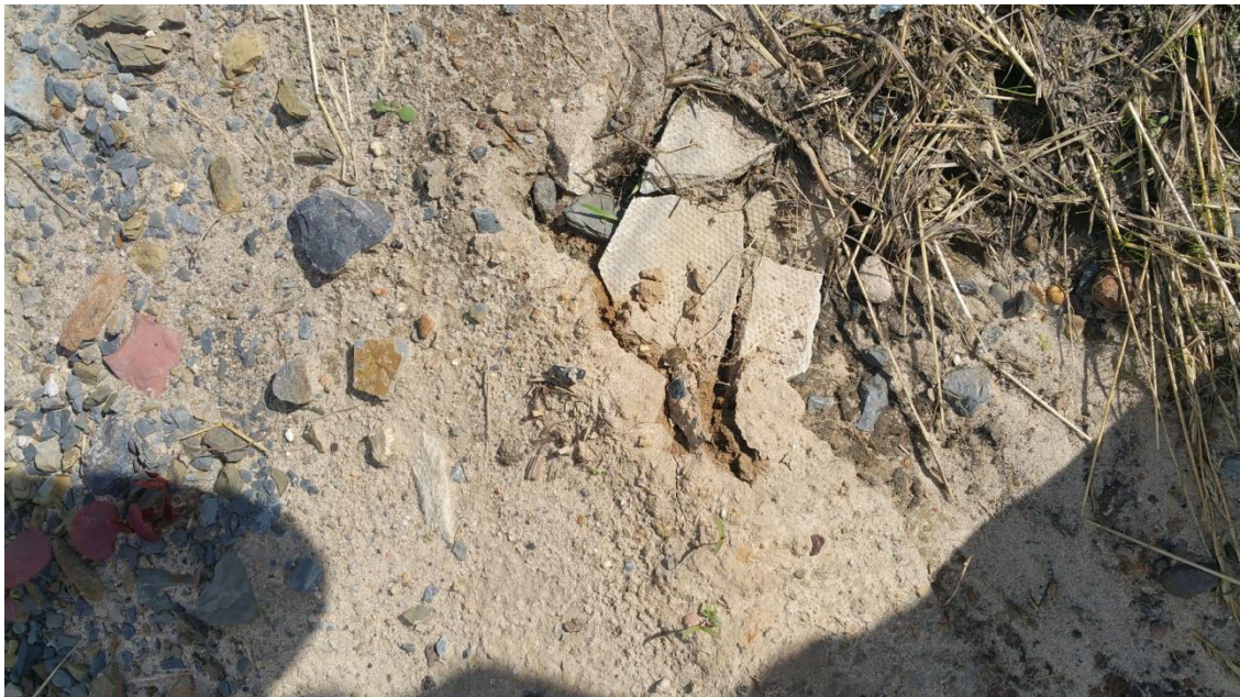
Foto: Fundstelle pot. Asbestzementbruchstücke im Randbereich zur Straße (ungefähre Lage: Probenahmestelle 1)
