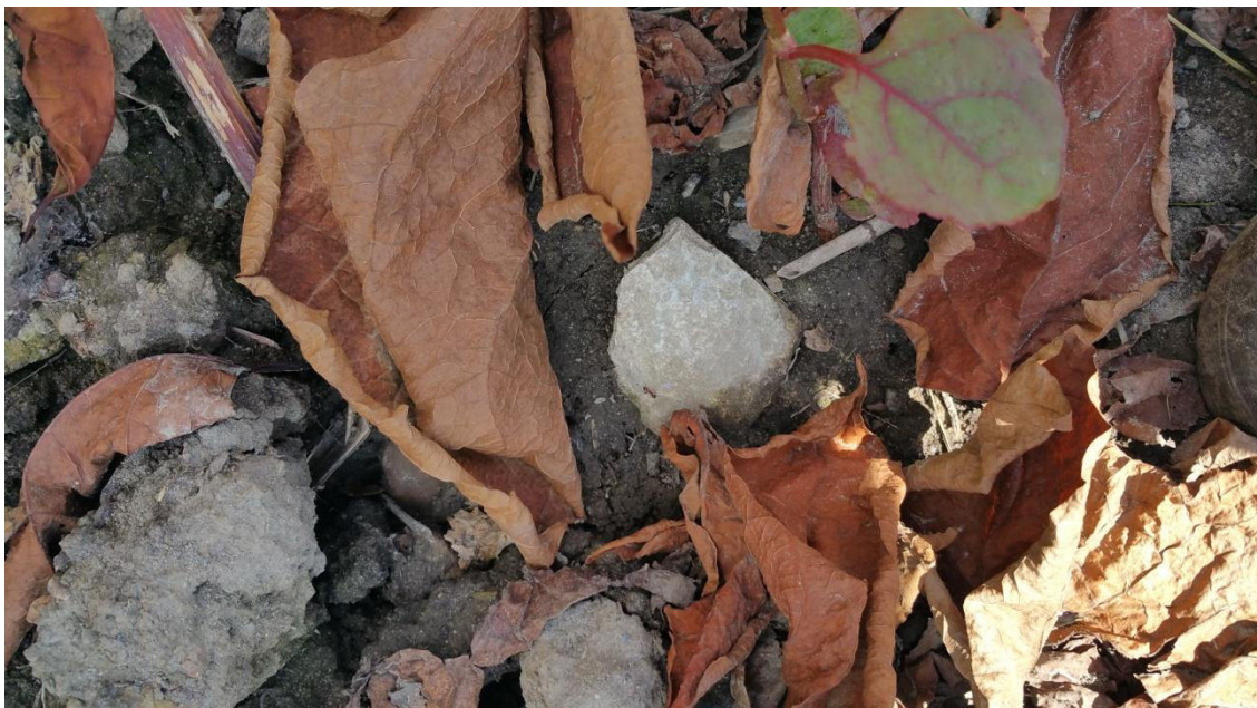
Foto: Fundstelle pot. Asbestzementbruchstücke im Randbereich zur Straße (ungefähre Lage: Probenahmestelle 3/4)
