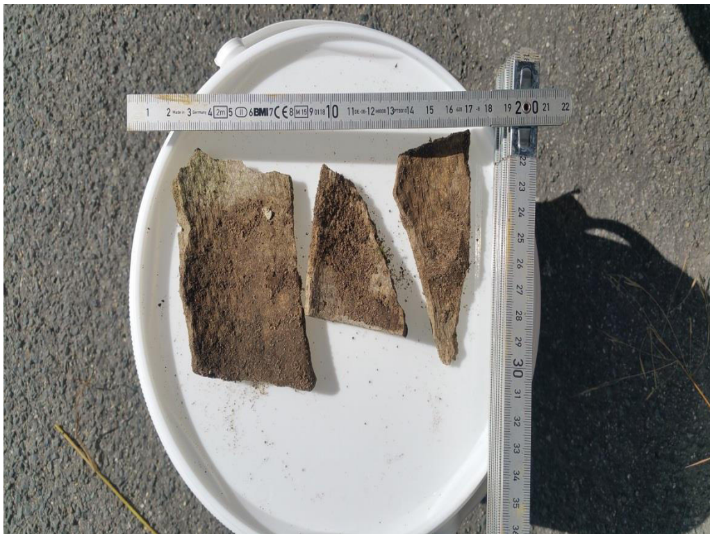
Abb. 8: Asbestzementbruchstückfunde aus dem Haufwerk im Verdachtsbereich 3.
